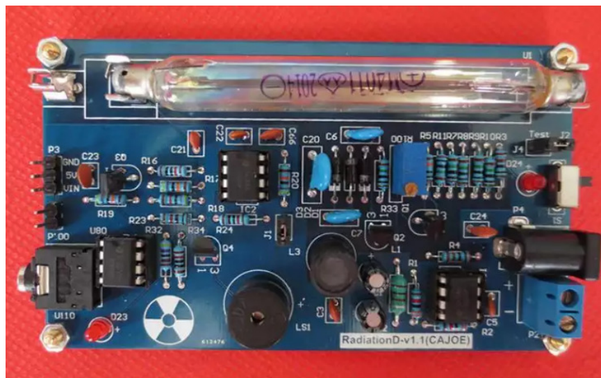
Figura 6. Módulo de medidas de radiação com tubo Geiger integrado ao sistema Arduino.
